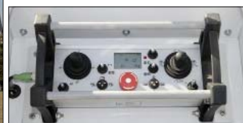
Schaltpult: Im Rettungskorb ist eine der Funkfernbedienungen verbaut.
