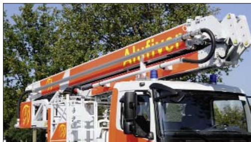
Wasser: Rechts am Teleskoparm ist die Wasserhochführung zum Werfer im Korb montiert.
