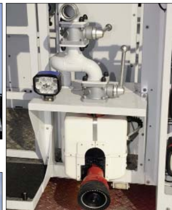
Fernsteuerung: Der Alco-Monitor im Rettungskorb lässt sich elektrisch über Fernbedienung steuern (1.300 l/min bei 10 bar).
