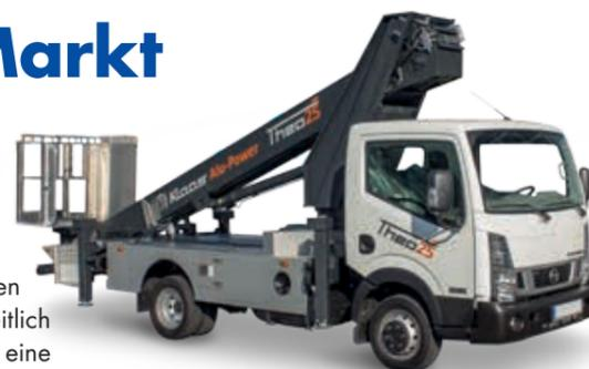
des 3,5-Tonnens erheblich. Die patentierte, wartungsarme Klaas Seiltechnik ermöglicht ein zügiges Teleskopieren unter Last, so dass auch schwer zugängliche Arbeitsbereiche problemlos erreicht werden können. Das geringe Eigengewicht der Seile wirkt sich positiv auf Ausladung und Tragkraft aus, die doppelte Seilführung erhöht die Sicherheit.
