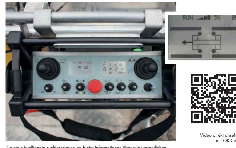
Die neue intelligente Funkfernsteuerung bietet Informationen über alle wesentlichen Betriebszustände des Kranes.
